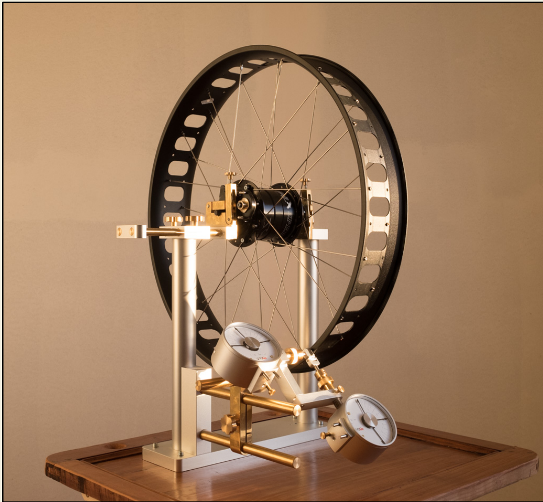
BANC DE CENTRAGE DE PRÉCISION P&K LIE. CALIBRATION DU BANC POUR CHAQUE ROUE, PRÉCISION AU 1/10 DE MM
